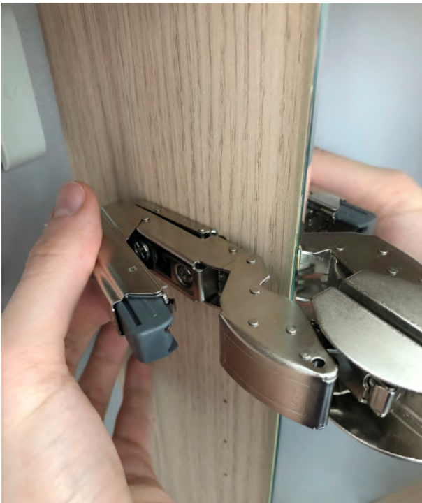
Abb. 4 | Montage von Glastürdämpfung und Abdeckkappe
