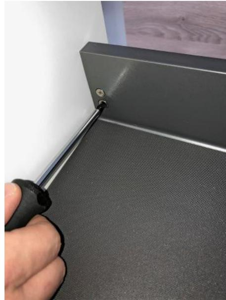
**3b.** Höhe mit der unteren Schraube ausrichten.
